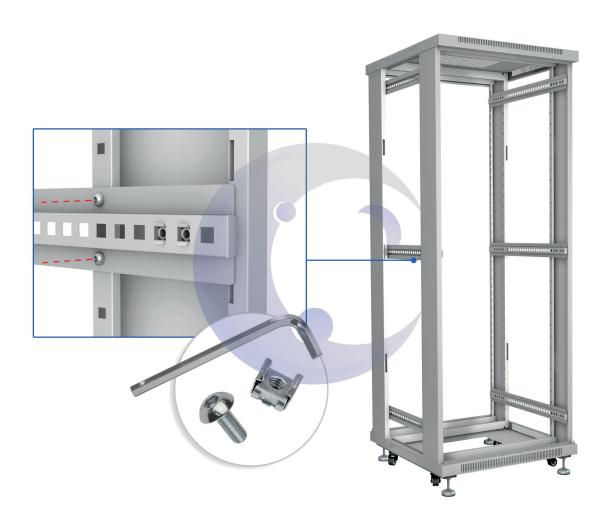
6 На боковые стороны шкафа устанавливаем по два или три направляющих профиля с каждой стороны, в зависимости от комплектации шкафа.
