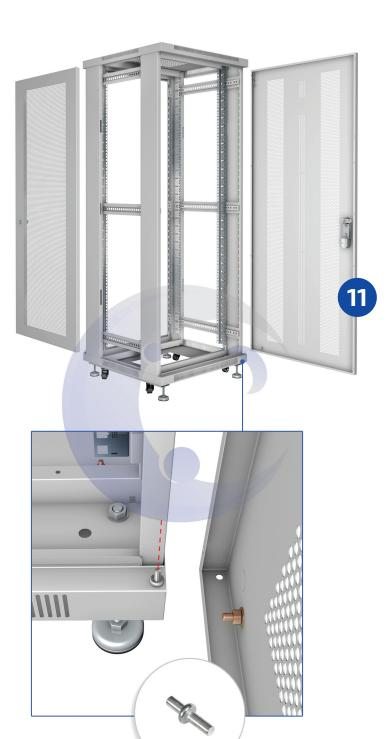
Устанавливаем шарнир двери в нижний угол каркаса и ставим на него низ двери. В верхней части двери оттягиваем вниз подпружиненный шпингалет навеса, заводим верхнюю часть двери в нужное положение, отпускаем шпингалет. Стержень шпингалета должен войти в отверстие в крыше шкафа.
