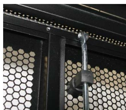
В шкафах с дверями двусторончатого (распашного) типа, помимо установки ручки с замком, необходимо также собрать систему запирания дверей, состоящую из собственно ручки (с замком) и присоединяемых механических тяг для фиксации закрытого положения двери в трех точках (посредине, вверху и внизу).
