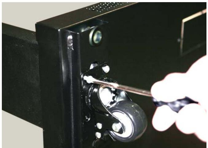
При помощи 16 самонарезающих винтов ST6,0x10 закрепите четыре высокопрочных 2" ролика к нижней панели шкафа. Для затяжки соединений используйте отвертку с крестообразным шлицем (Phillips).
