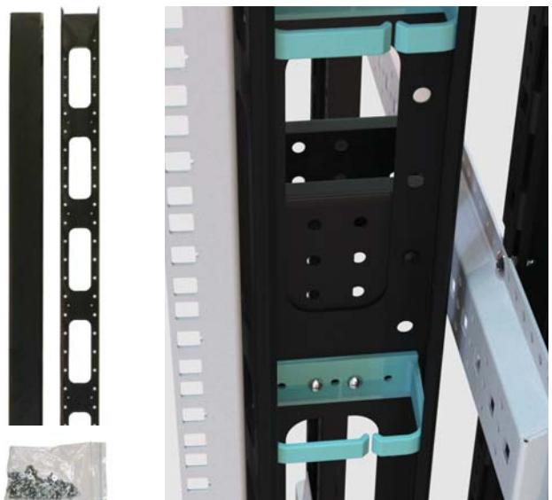
Вертикальные кабельные организаторы<sup>1</sup> фиксируются винтами ST5,5x10 в два боковых отверстия в креплениях для 19" монтажных профилей<sup>1</sup>.
