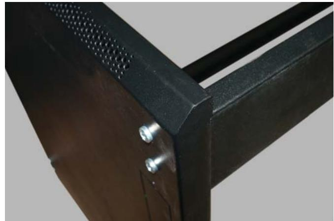
При соединении верхней панели с рамами каркаса вначале вставляйте винты M8 в отверстия, размещенные ближе к центру шкафа. Каждый винт затягивайте гайкой M8. Затем устанавливайте винты в отверстия, которые ближе к краю шкафа.
