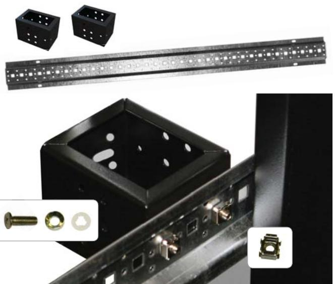
Каждое крепление для 19" монтажных профилей<sup>1)</sup> фиксируется к горизонтальным монтажным профилям при помощи двух винтов M6 в комплекте с закладными гайками. Под каждый винт подкладывается вначале высокая металлическая шайба, а затем тонкая пластиковая.
