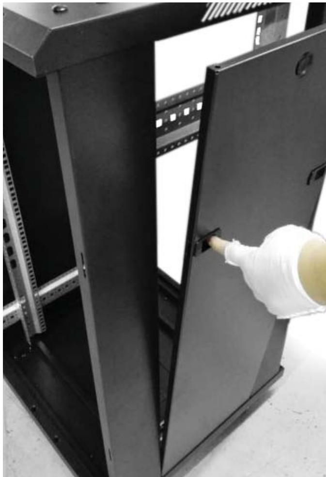
Установите боковую панель сначала внизу шкафа, а затем прижмите ее верхнюю часть, фиксируя закрытое положение двумя защелками.
