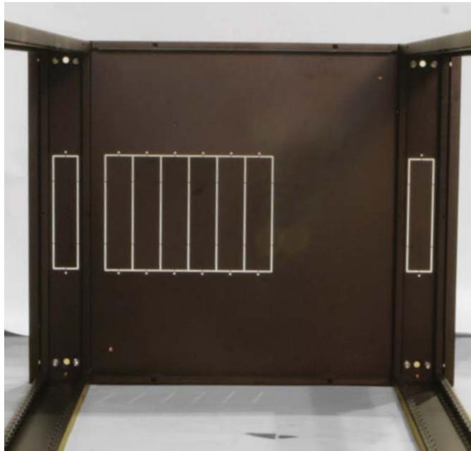
Вставьте переднюю и заднюю рамы каркаса в нижнюю панель шкафа (панель-пол) и затяните соединения при помощи восьми винтов M8 и фланцевых гаек.
