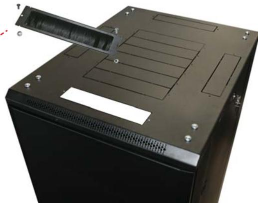
Щеточный кабельный ввод крепится двумя винтами M4x8 и гайками. Для его установки удалите выламываемую заглушку в соответствующей панели (вверху или внизу шкафа).
